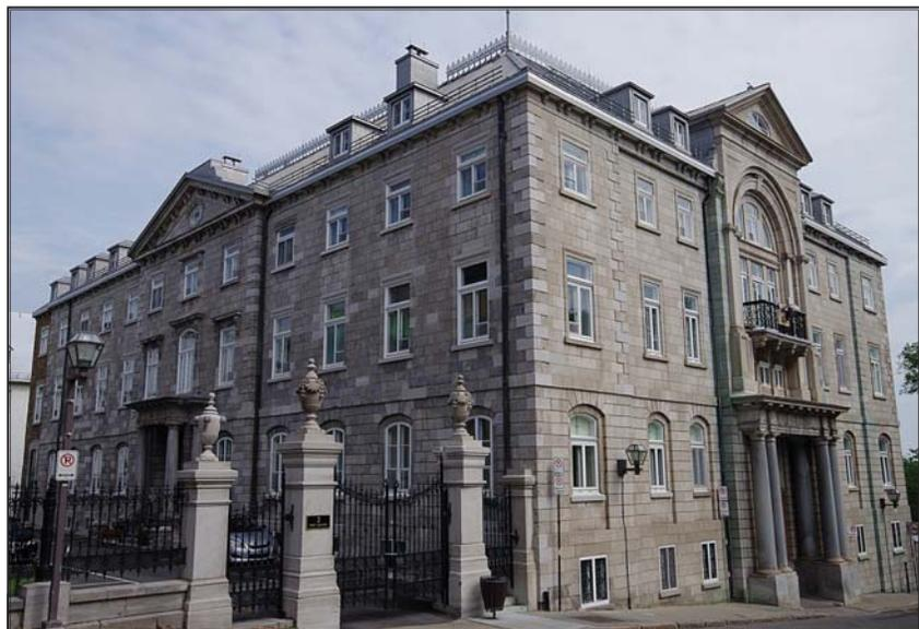
**Palais archiépiscopal** : la façade et le portail de la rue du Parloir sont en calcaire de Pointe-aux-Trembles; la façade en trompe-l'œil, les piliers et les urnes sur la rue Port-Dauphin sont en calcaire de Saint-Marc-des-Carières; et les colonnes du portail sont en granits Gris Stanstead et Rouge de St-George.
